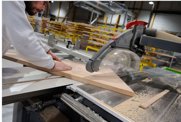
Scie à bois équipée d'un dispositif de captage des poussières
